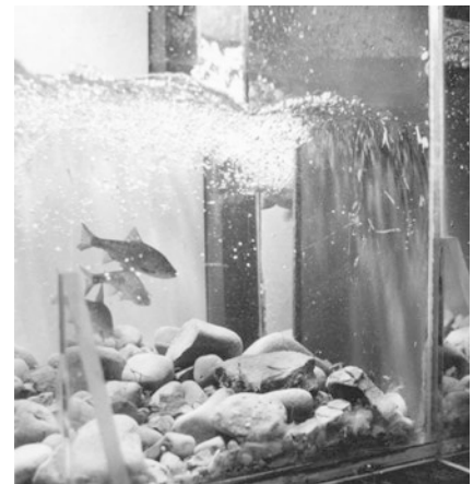
Bild 7: Rotaugen im Strömungsschatten des Umlenkblocks. Von hier aus starten sie zum Durchschwimmen des Schlitzes (Quelle: [3])
